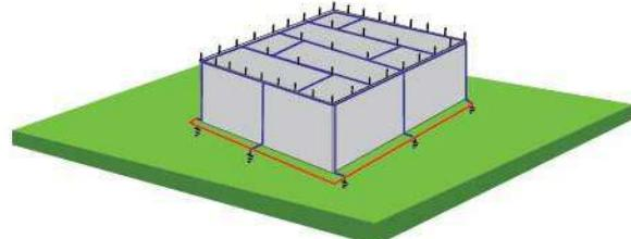
и вертикальными проводниками, образуя клетку. На крыше через определенные промежутки размещаются острые вертикальные стержни, соединенные с клеткой. Клетка соединена с землей через многие точки с помощью проводников в земле и электродов заземления.
