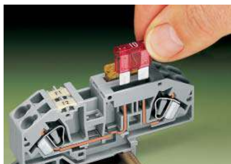
Замена предохранителя
