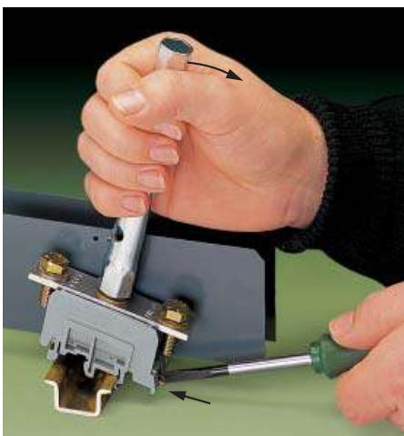
Демонтаж с DIN-рельса 35 мм
