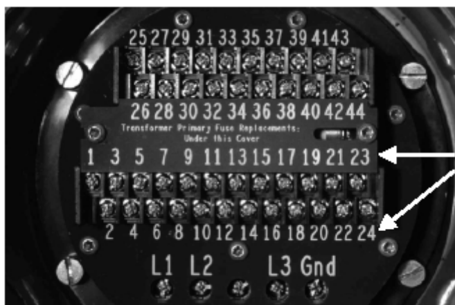
Рис. 3-22. Подключение блока дистанционного управления
