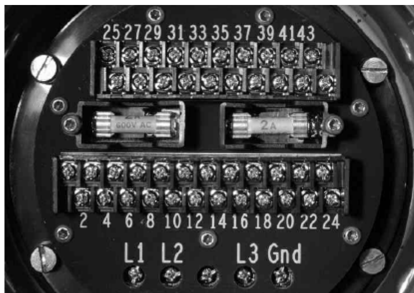
Рис. 7-1. Плавкие предохранители в блоке подключения
