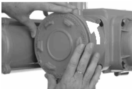
Рис. 3-2. Снятие крышки блока подключения
