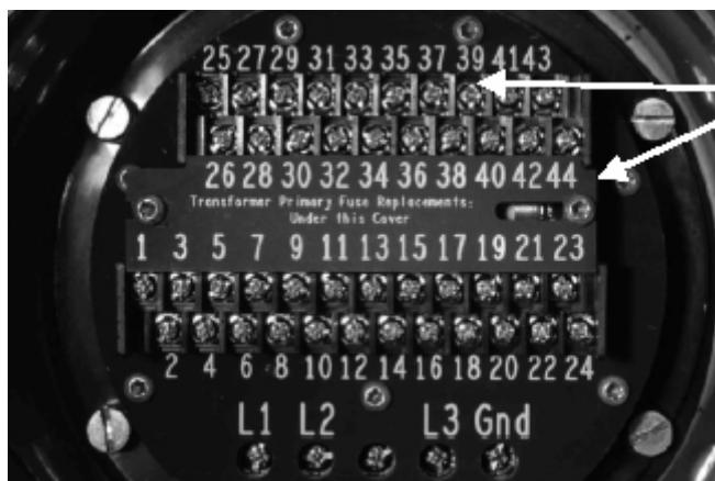
Рис. 3-21. Подключение дополнительного релейного блока
