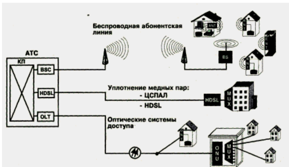
Рис. 1.15. Три способа решения проблемы "последней мили" (BSC - контроллер базовой станции системы радиодоступа. BS - базовая станция, RTU - абонентский оконечный блок; HDSL - оборудование цифровой абонентской линии; OLT, ONU, QNT - линейные комплекты оптической системы передачи; MUX - мультиплексор)
