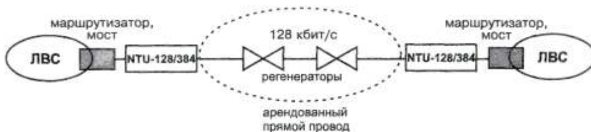
Рис.3.4. Применение модемов для физических линий для соединения ЛВС по прямым проводам
