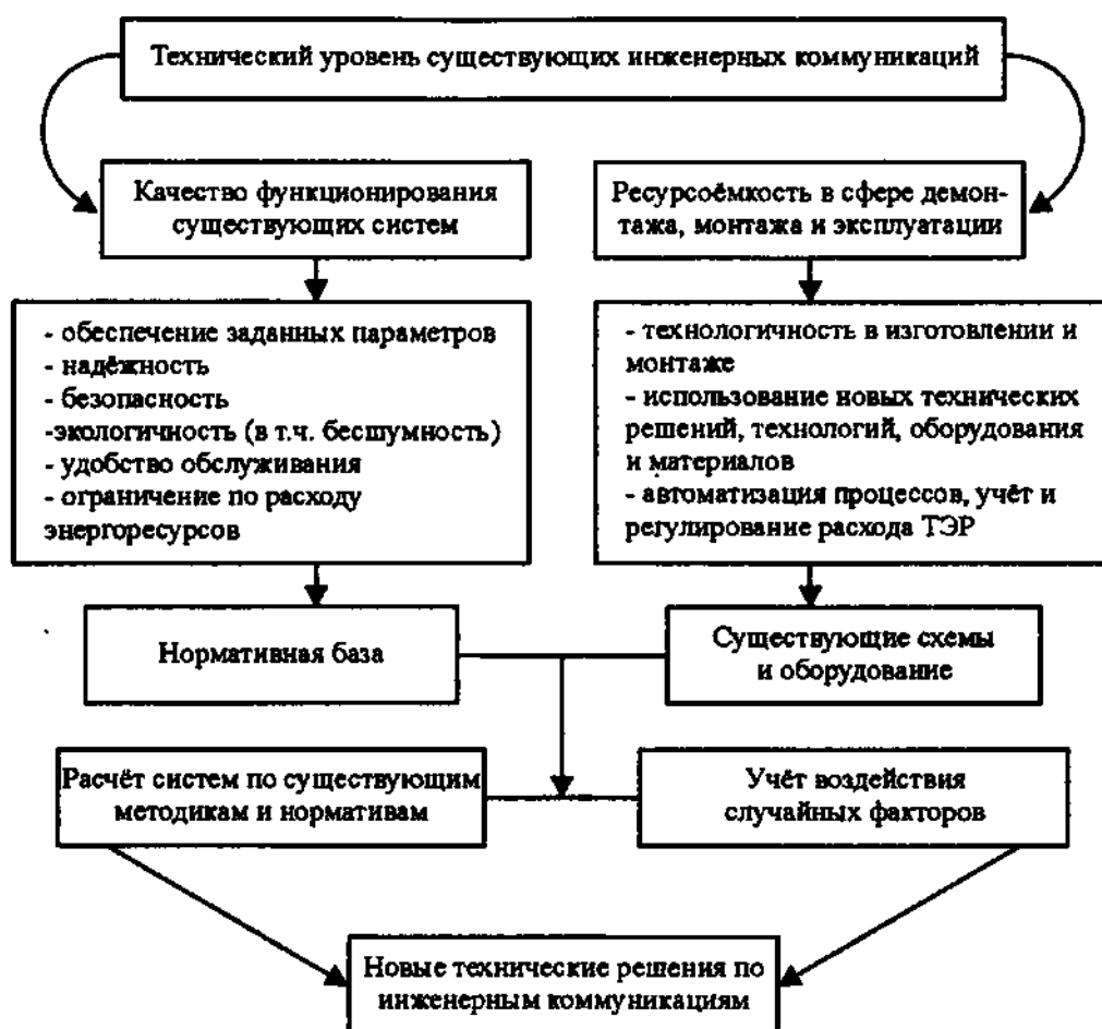
Рис. 6.3.1. Схема особенностей влияющих на технический уровень при обследовании существующих инженерных сетей
