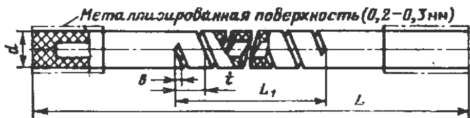
Рис. 3.10. Электронагреватель хромитлантановый спиральный
