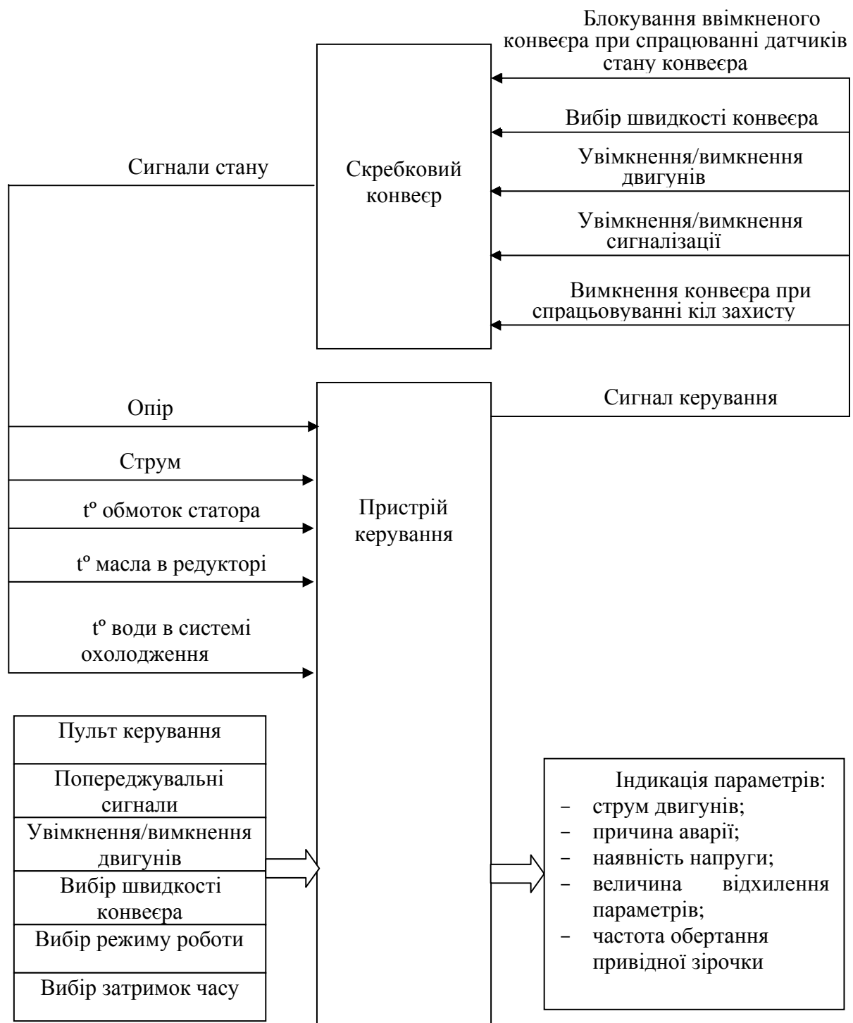
Рис. 2.44. Структурна схема системи керування скребковим конвеєром
