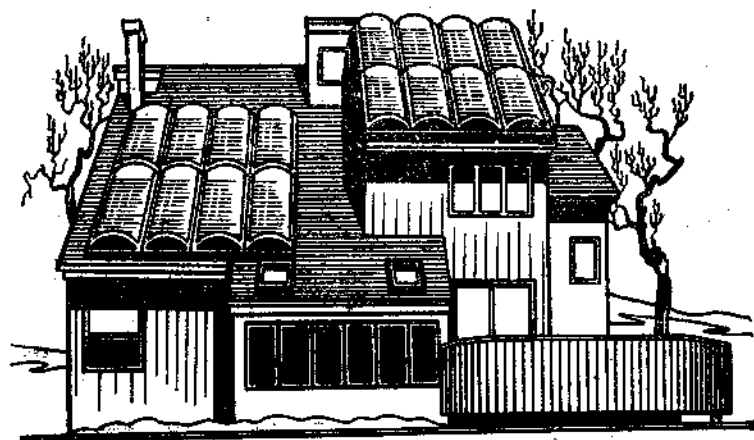
Рис. 81. Жилой дом с солнечными коллекторами на крыше
