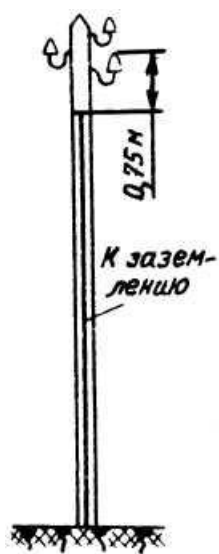
Рис. 23. Защитный промежуток на опоре ВЛ напряжением 3–20 кВ с заземляющим спуском
