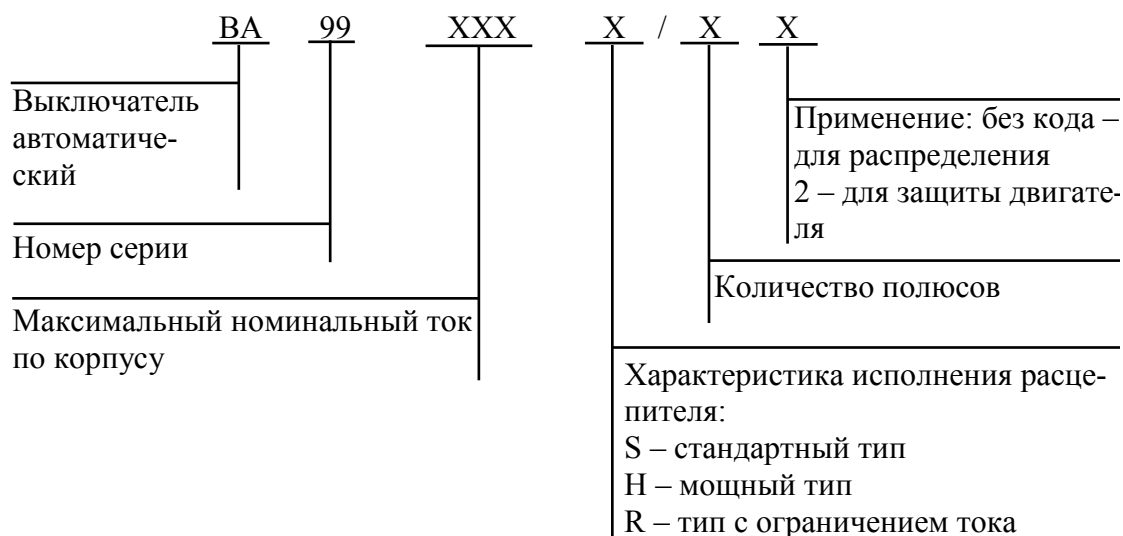
Рис. 2.145. Структура условного обозначения автоматических выключателей ВА99 ЩИТ
