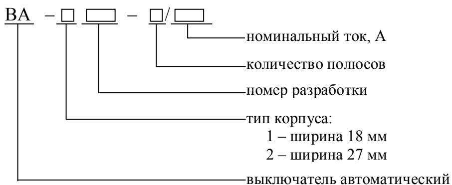
Рис. 2.162. Структура условного обозначения автоматических выключателей ВА-101, ВА-102, ВА-103, ВА-201
