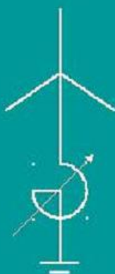
заземление через дугогасящий реактор
