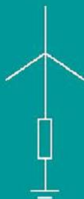
заземление через резистор
