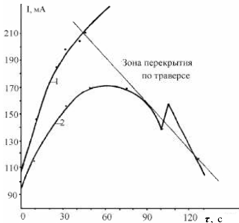
Рис. 66. Изменение тока по траверсе длиной 200 (1) и 400мм (2), консервированной ХМ-11, в зависимости от длительности воздействия переменным напряжением 6 кВ
