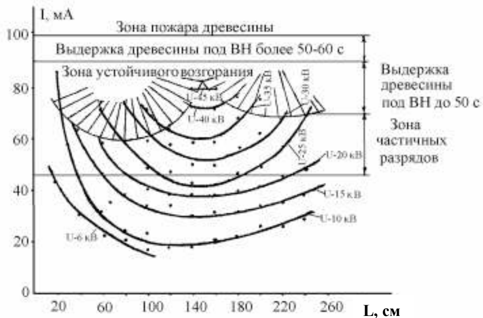
Рис. 61. Зависимости тока проводимости от длины траверсы, консервированной КМ, при постоянном воздействии переменным напряжением
