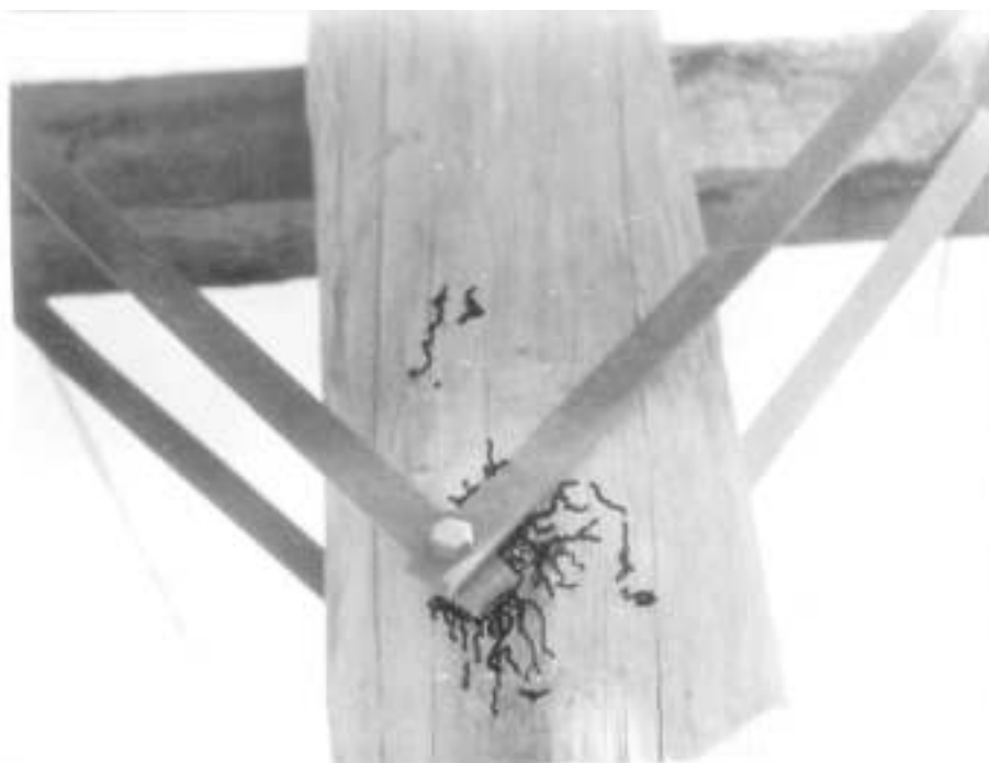
Фото 20. Образование треков в зоне крепления укосины к опоре. Де- фект № 4
