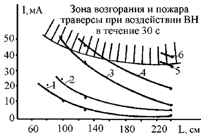
Рис. 62. Усредненные зависимости тока проводимости от длины траверсы, консервированной КМ, при постоянном воздействии переменным напряжением в течение 30 с: 1 - 6 кВ; 2 - 10 кВ; 3 - 15 кВ; 4 - 20 кВ; 5 - 25 кВ; 6 - 30 кВ. Срок эксплуатации траверсы на участке ВЛ Барса-Кельмес - Ажинияз - 7 лет
