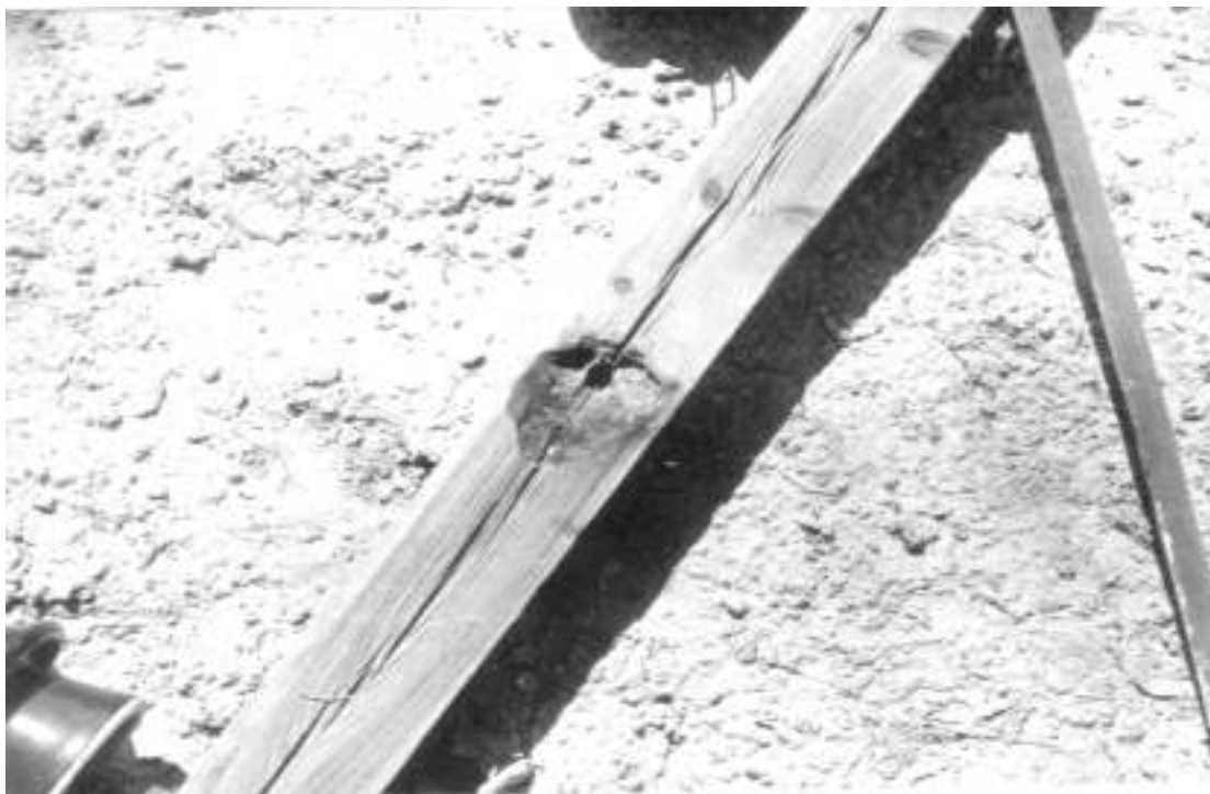
Фото 28. Следы пожара на траверсе снятой в 1989 г. на участке ВЛ Кырк-Кыз - Рзд. 700 км. Срок эксплуатации 2 года. Дефект № 9
