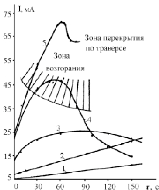
Рис. 65. Изменение тока по траверсе длиной 2300 мм, консервированной КМ, в зависимости от длительности воздействия переменным напряжением: 1 - 6 кВ; 2 – 10 кВ; 3 - 15 кВ; 4 – 20 кВ; 5 – 25 кВ. Срок эксплуатации траверсы на участке ВЛ Барса-Кельмес - Ажинияз - 7 лет
