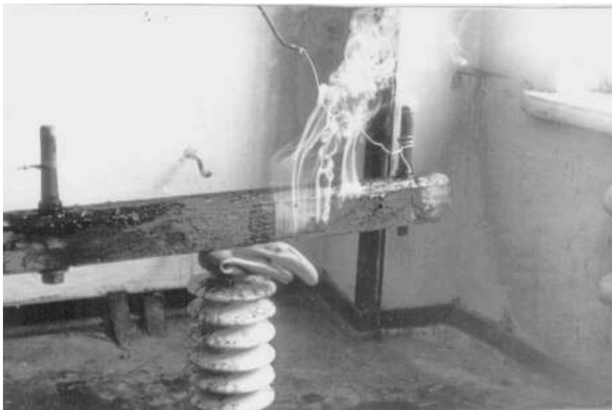
Фото 50. Лабораторные исследования токовременных характеристик деревянных траверс длиной 2500 мм. Антисептик - КМ
