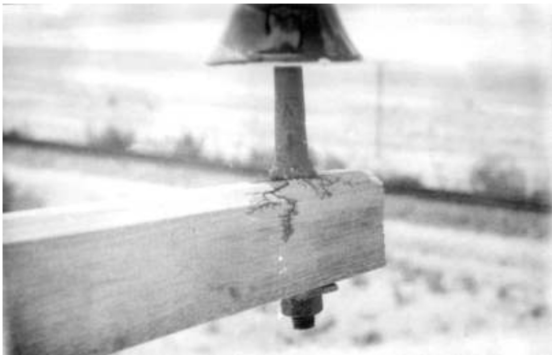
Фото 21. Образование треков на поверхности траверсы под штырем. Дефект № 5
