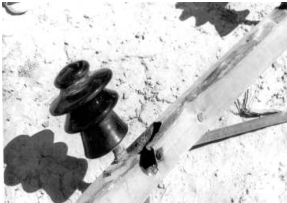
Фото 26. Следы пожара на траверсе, снятой в 1989 г. на участке Кун-ходжа - Рзд. 680 км. Срок эксплуатации 2 года. Дефект № 7
