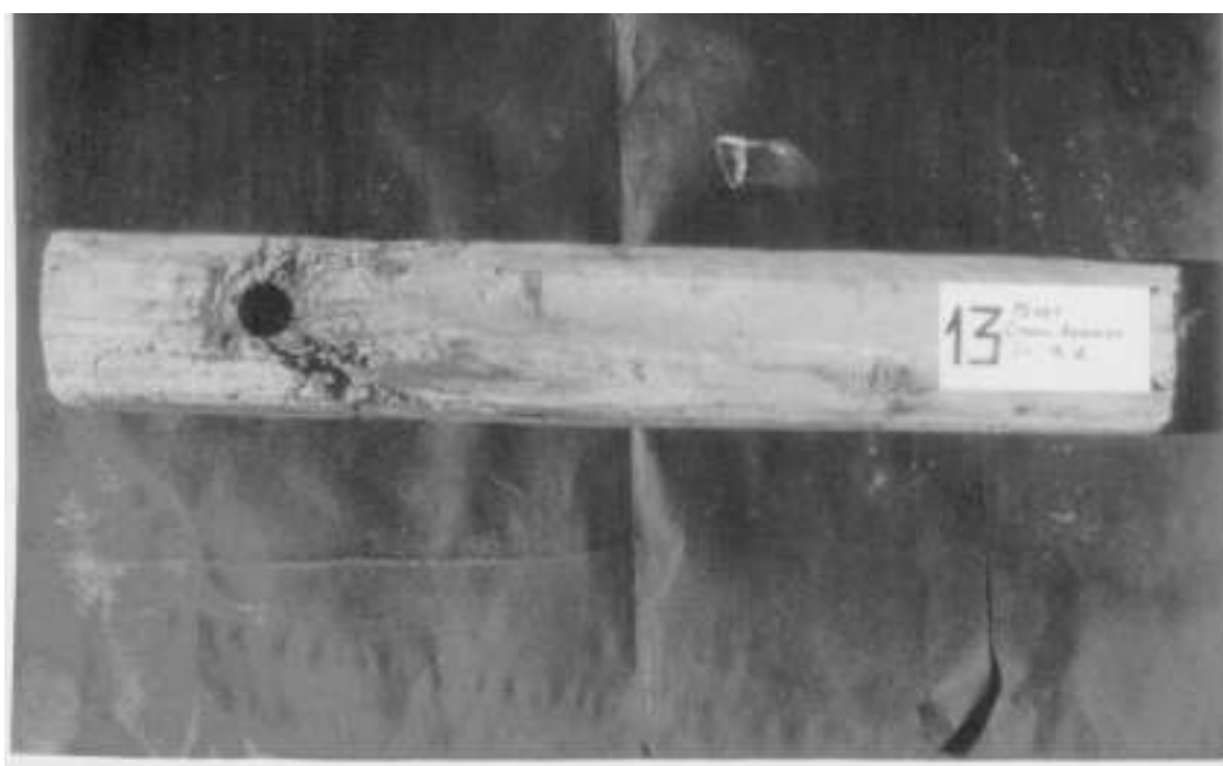
Фото 32. Многочисленные следы возникновения пожара на траверсе. Наибольшая глубина треков составляет 1,8 см. Снята в 1988г.
