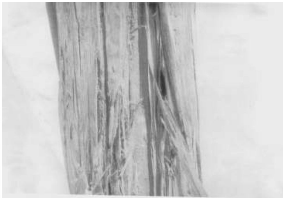
Фото 14. Разрушение древесины опоры ВЛ 10 кВ на участке Мары-Дорт-Кую. Срок службы опоры более 15 лет
