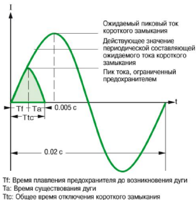
Рисунок 77. Ограничение тока плавким предохранителем.
