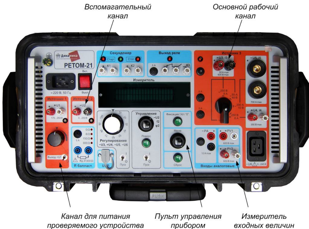
Рис. Г.6 Панель лицевая РЕТОМ-21
