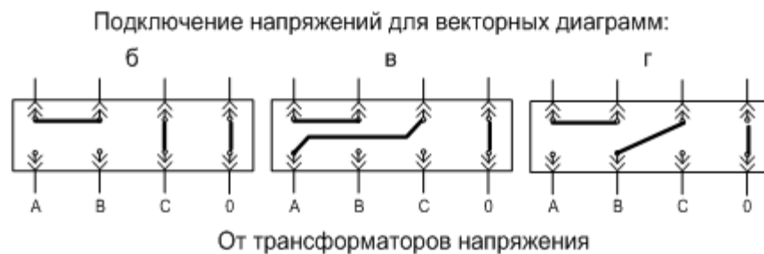
Рис. 25 Определение ожидаемого поведения реле сопротивления при переводе в режим направления мощности при подведении рабочих токов и напряжений
