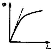
Рис. 3.15. Вебер-амперная характеристика двигателя постоянного тока последовательного возбуждения
