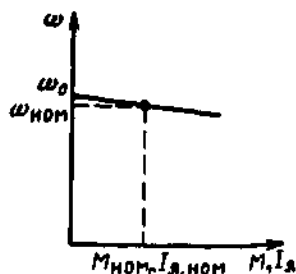
Рис. 36. Естественная механическая и электрохимическая характеристики двигателя постоянного тока независимого возбуждения при U_{ном} , \Phi_{ном} , R_p=0
