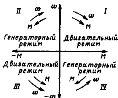
Рис. 3.3. Области режимов работы электропривода
