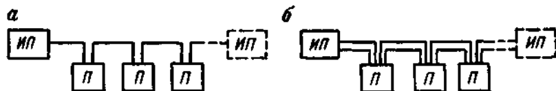
Рис. 9.5. Цепочные магистральные схемы распределения электроэнергии:
