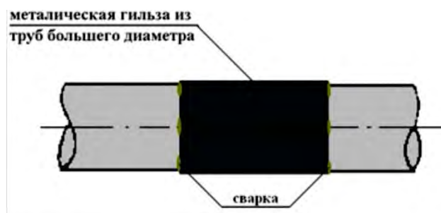
Рисунок 5.43 – Соединение труб с помощью гильз
