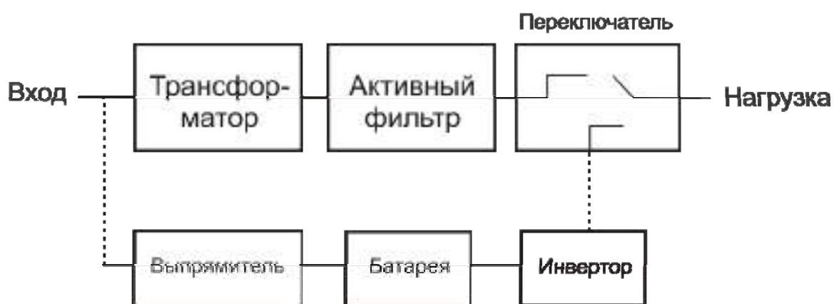
Рис. 8.32. Источник бесперебойного питания типа Line-Interactive
