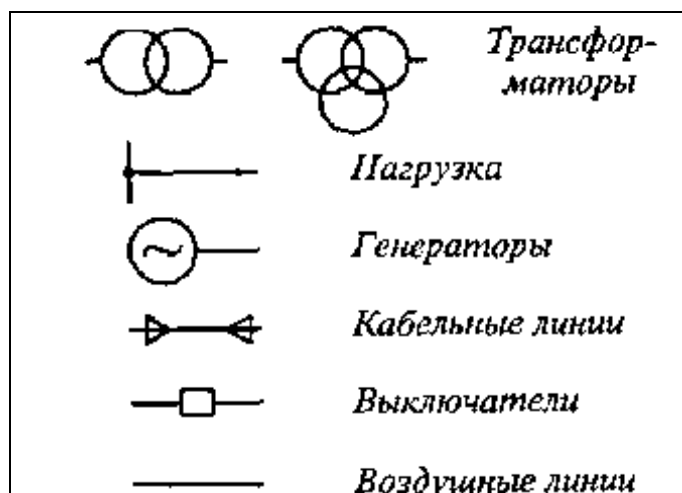
Рис. 1.2. Условные обозначения элементов системы основных элементов электроэнергетической системы.
