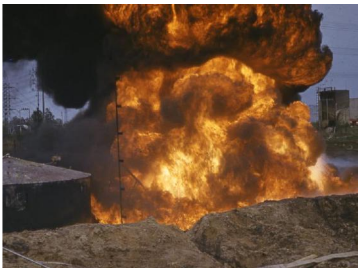
Рис. 13.1. Экспериментальные исследования, проведенные Академией ГПС МЧС России, по изучению пожарной опасности резервуара в условиях пожара
