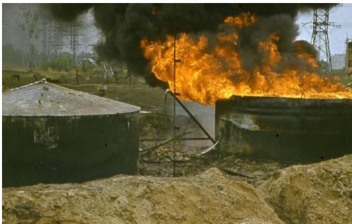
Рис. 5.2. Экспериментальные исследования, проведенные Академией ГПС МЧС России, по изучению пожарной опасности резервуара, расположенного рядом с горящим резервуаром
