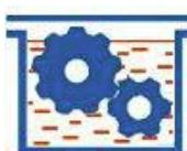
Вид взрывозащиты, при котором обеспечивают неэффективность потенциальных источников воспламенения или отделяют их от взрывоопасной среды путем полного погружения в защитную жидкость или путем частичного погружения
