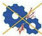
Вид взрывозащиты, в которой применены конструкционные меры для защиты от возможного воспламенения от нагретых поверхностей, искр и адиабатического сжатия, производимых движущимися частями.
