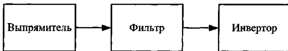
Рис. 2.34. Структура преобразователя частоты
