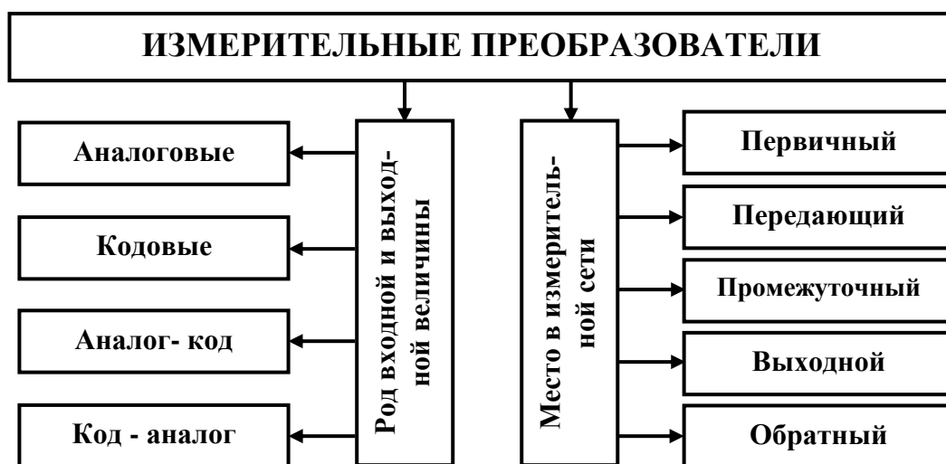
Рисунок 2.4 - Классификация измерительных преобразователей
