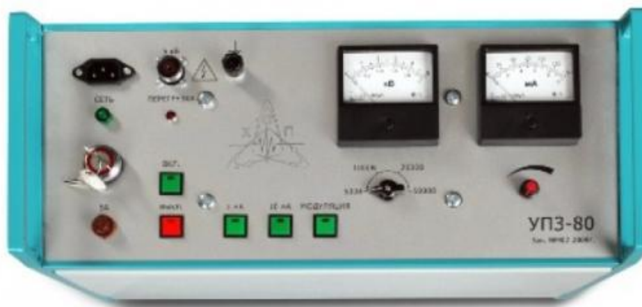
Рисунок 2.11 - Установка испытания оболочек кабеля с изоляцией
