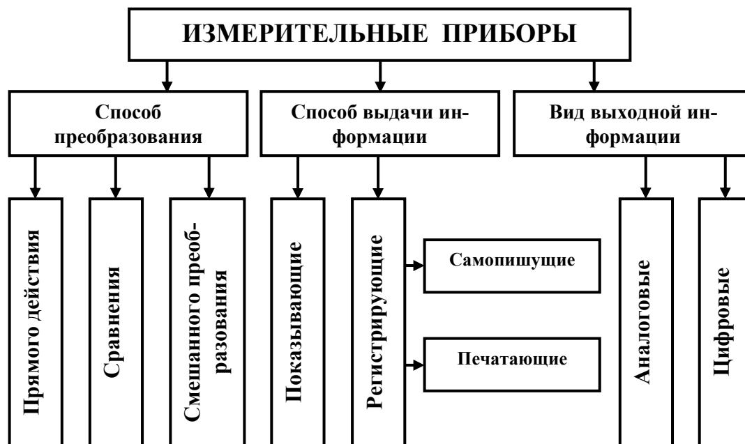
Рисунок 2.2 – Классификация электрических измерительных приборов
