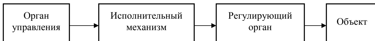
Рис. 1.2. Структурная схема системы дистанционного управления
