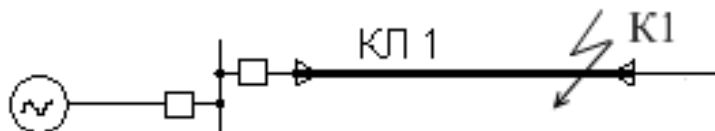
Рисунок 3.1 – Расчетная схема участка электрической сети 110 кВ с КЛ-1
