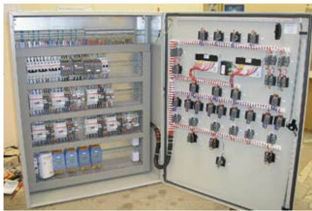
Рис. 60. Шкаф управления тепловым пунктом
