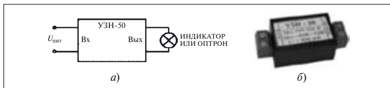
Рис. 24. Схема подключения (а) и внешний вид (б) устройства защиты от наводок 1
