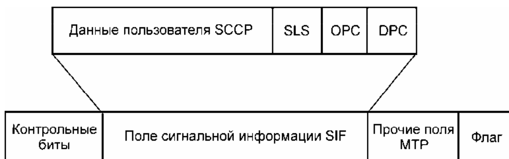
Рис. 5.11. Структура сообщения SCCP и его связь с MTP
