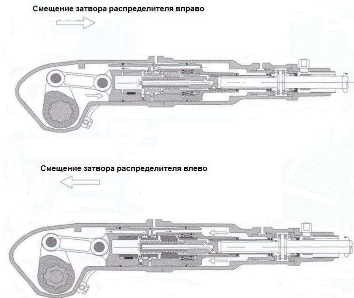
Рис.4.22. Приводы рулевого управления фирмы “Цанрадфабрик (Zahnradfabrik)” с затвором, смещенным в крайние позиции
