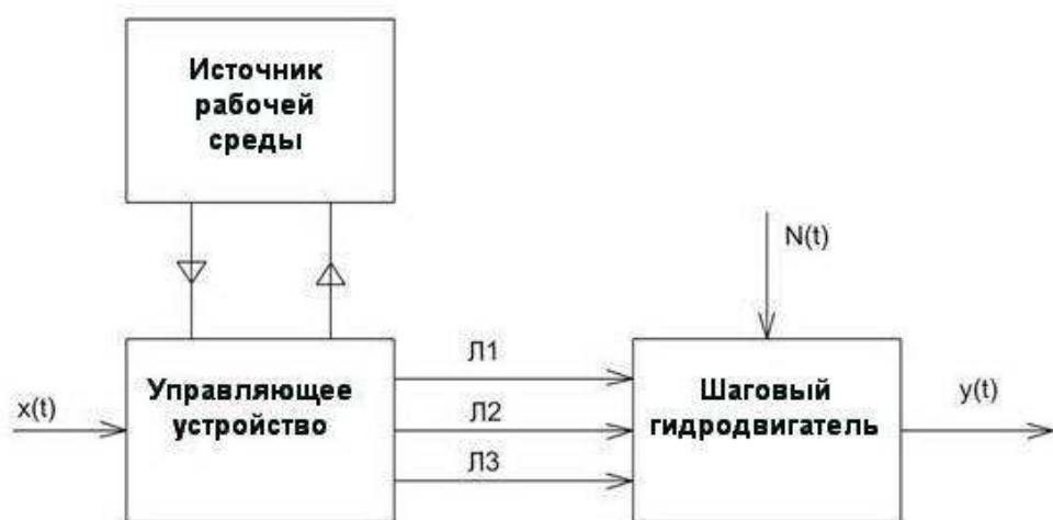
Рис.5.1. Структурная схема шагового гидропривода
