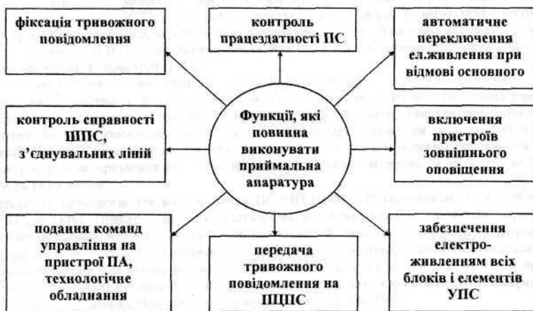
Рис. 3.1. Функції, що виконуються приймальною апаратурою УПС
