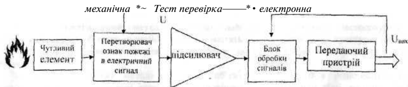
Рис. 2.1.1. Загальна схема будови сучасного дискретного пожежного сповіщувача
