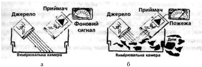
Рис. 2.3.12. Умовна схема чутливої камери оптичного димового ПС
