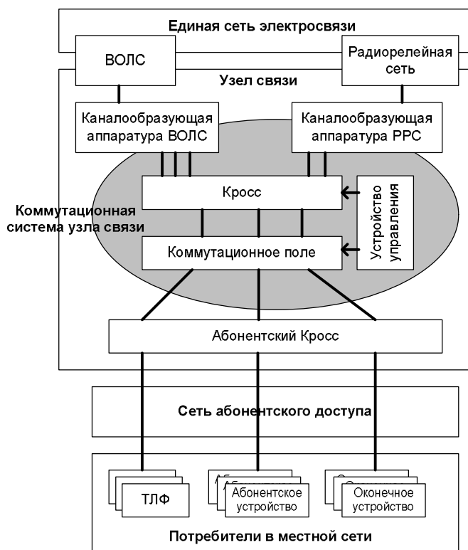
Рис. 3.12. Обобщенная структурная схема узла связи
