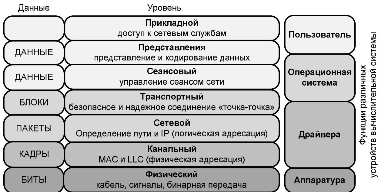
Рис. 2.2. Функции уровней модели OSI, представление данных на различных уровнях, а также соответствие им функций различных устройств вычислительной системы
