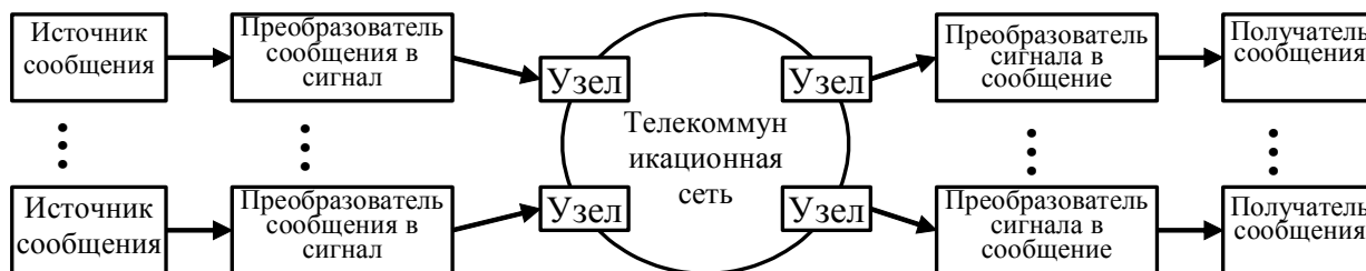
Рис. 3.11. Схема взаимодействия абонентов через телекоммуникационную сеть
