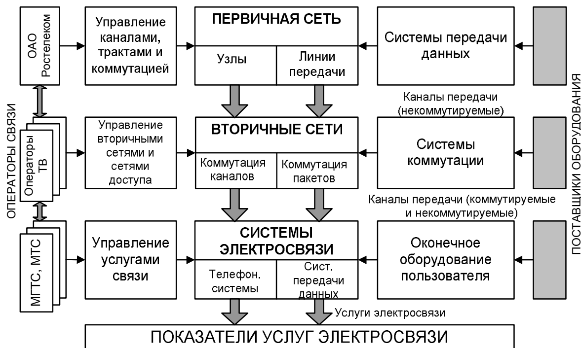
Рис. 3.3. Архитектура ЕСЭ
