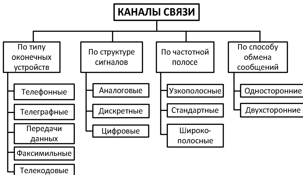
Рис. 1.3. Классификация каналов связи
