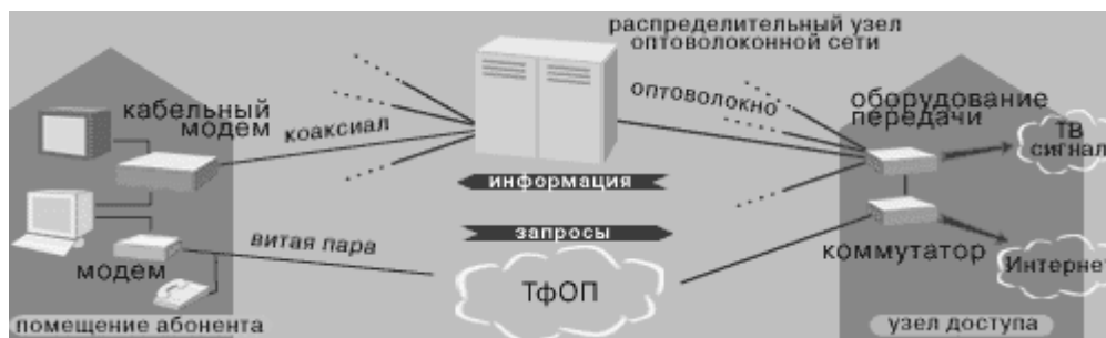
Рис. 6.5. Гибридная система кабельного телевидения, построенная на комбинации оптоволоконных и коаксиальных кабелей
