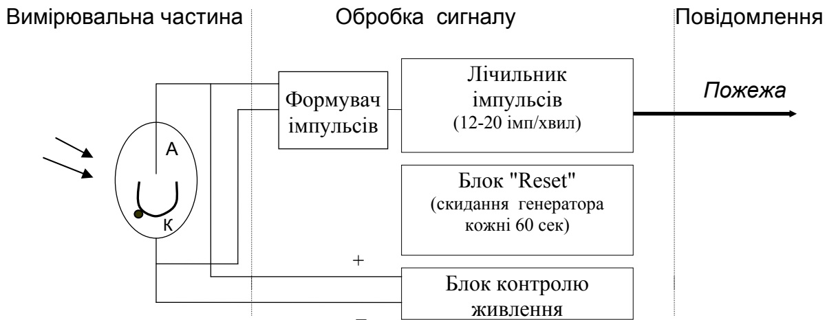
Рис. 4.3 - Структурна схема сповіщувача полум'я УФ типу
