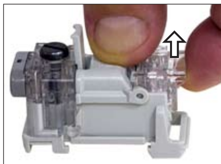
Рисунок 4.2 – Подключение жил кабеля со станционной стороны модуля
