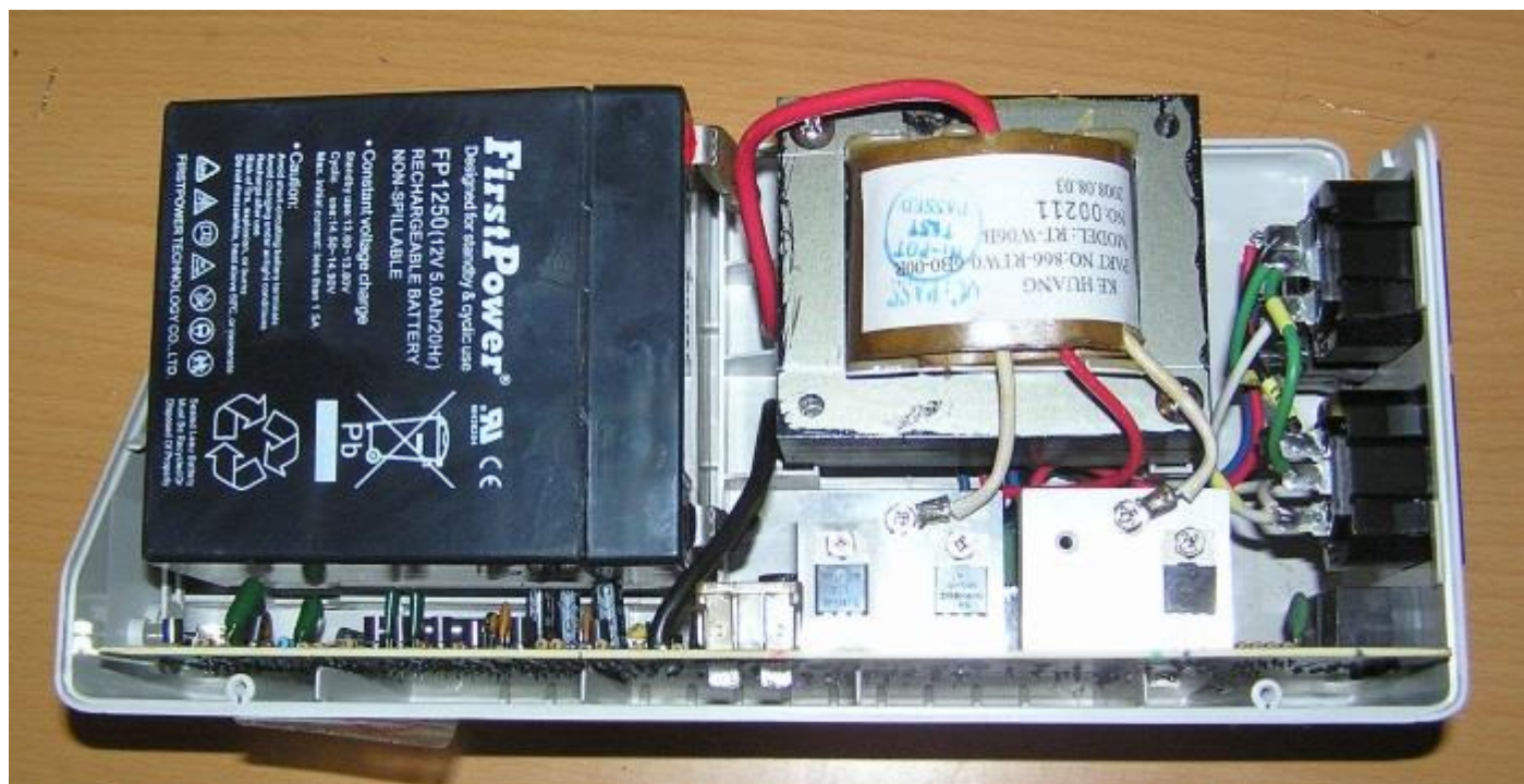
Рис. 3.2. Вид ИБП со стороны задней стенки – в месте подсоединения кабелей: сетевого и 2-х нагрузочных
