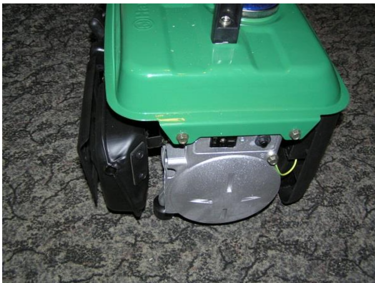
Рис. 3.8. Непрофессиональная бензоэлектростанция Hammer GNR 800A со стороны мотора
