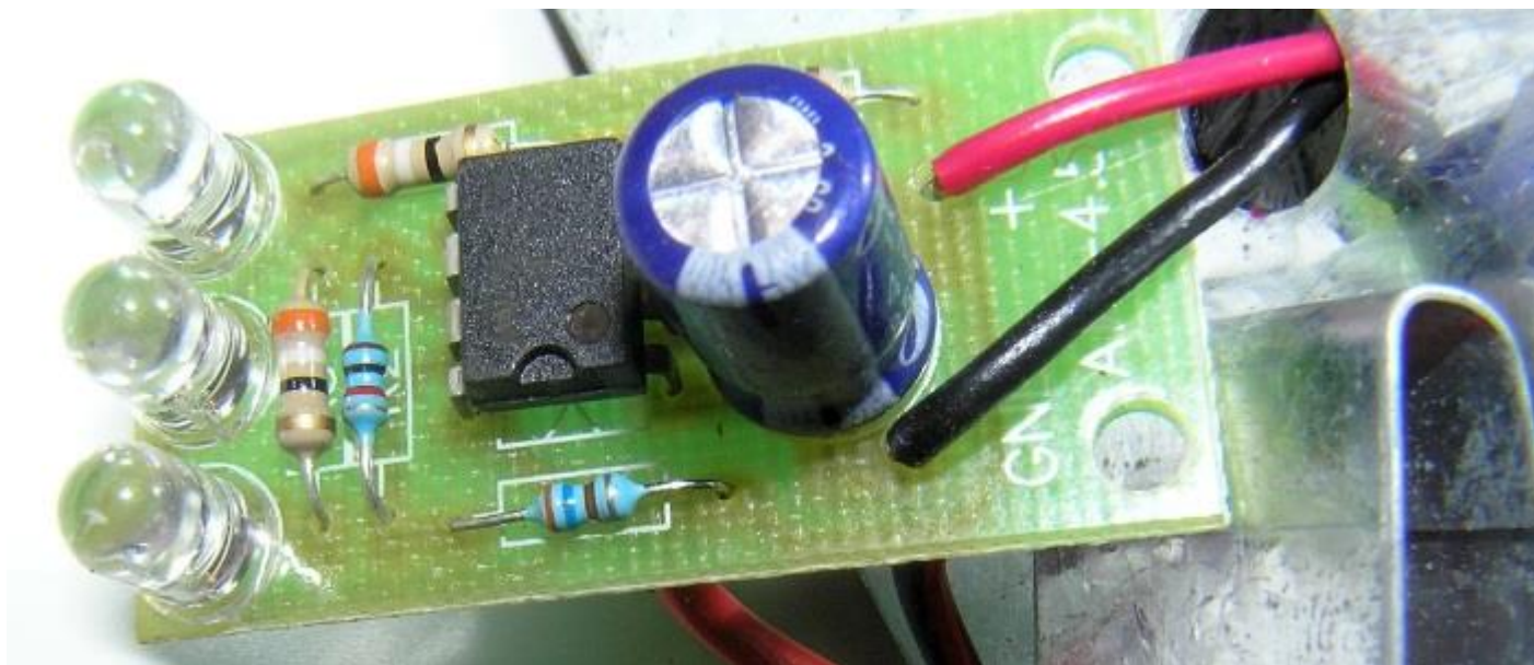
Рис. 2.10. Вид на плату светодиодного маячка
