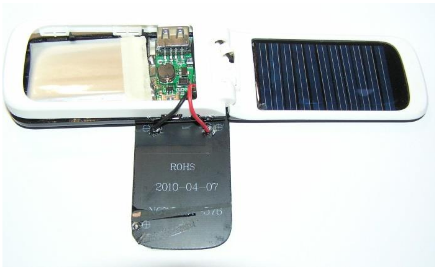
Рис. 2.22. Вид на раскрытый корпус Solar Charger и обратную сторону элемента солнечной батареи
