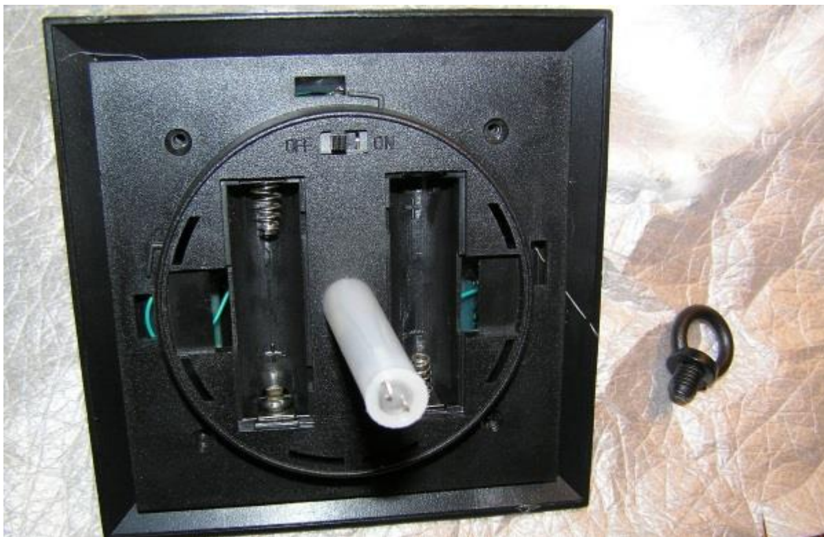
Рис. 1.17. Конструкция матовой трубки со светодиодом оранжевого свечения
