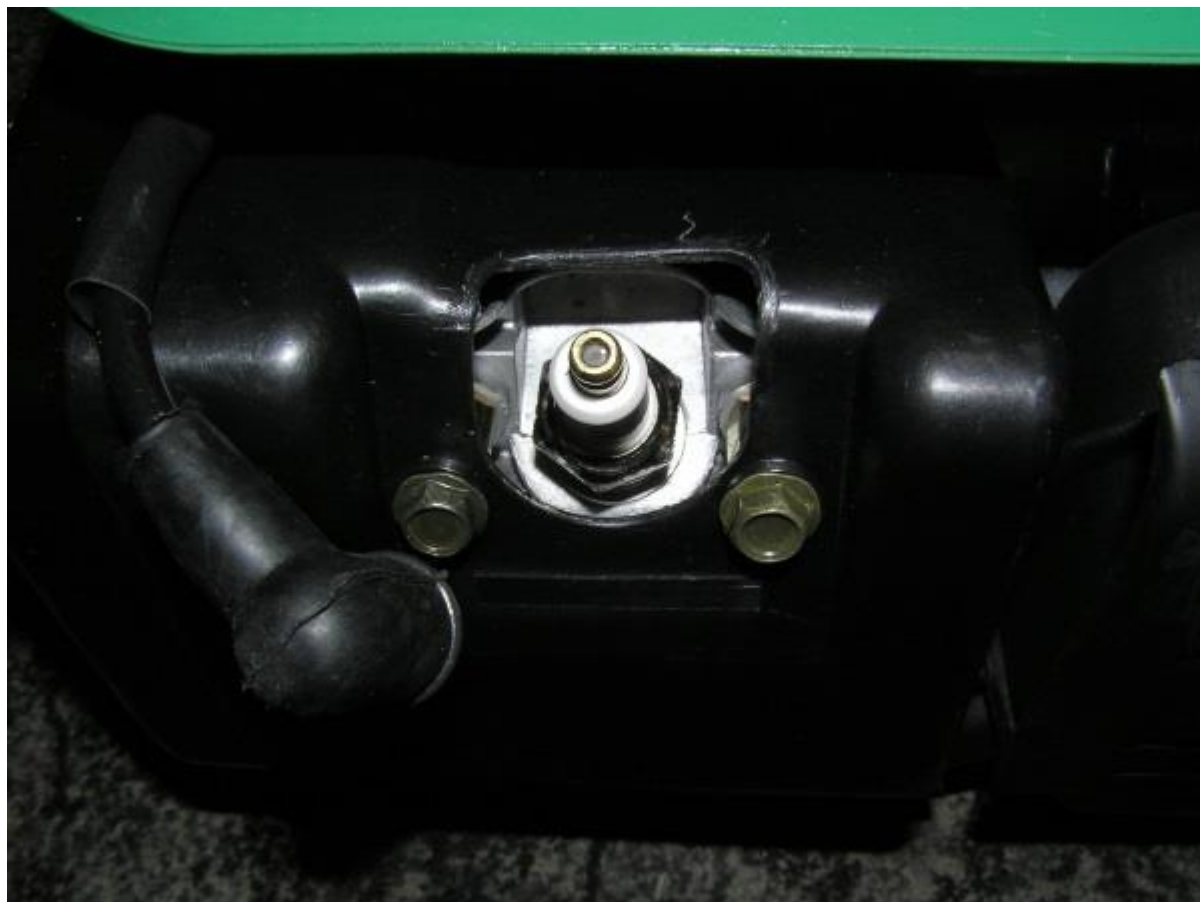
Рис. 3.9. Свеча зажигания на двигателе с боковым расположением клапанов
