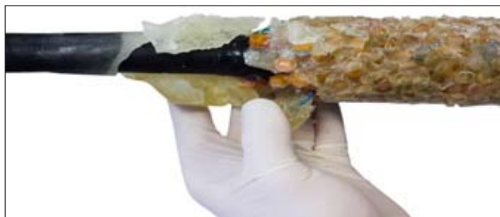
Рисунок 4.3 – Скрошивание герметика
