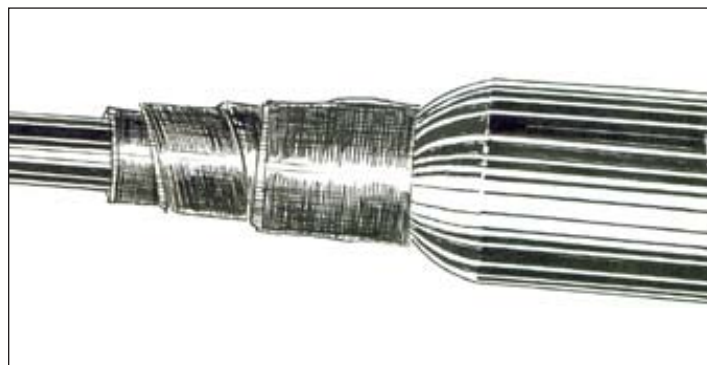
Рисунок 3.9 – Конусная часть муфты с намотанной лентой VM
