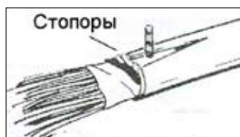
Рисунок 3.2 – Установка основания соединителя 4462
