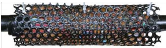
Рисунок 3.6 – Скрепленная на сrostке сетка
