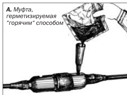
Рисунок 3.14 – Заливка герметика в муфты
