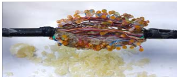
Рисунок 4.4 – Сросток после полного скрошивания герметика
