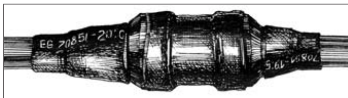
Рис. 4.21. - Смонтированная муфта МГНМс 40/66 (МГНМс 60/77).
