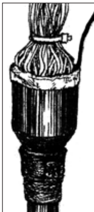
Рис. 4.23. - Смонтированная муфта УВГНМг
