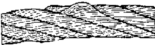
в) выдавливание проволок в одной пряди
