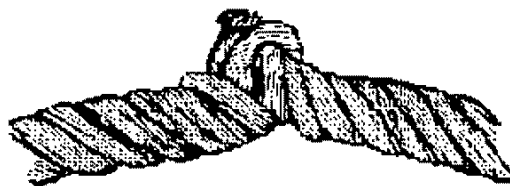
ж) перекручивание каната
