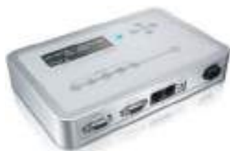
iPlayer® 3 производства компании Philips Color Kinetics является компактным контроллером светодиодной системы освещения, способным управлять двумя отдельными DMX-системами с 512 адресами каждая.
