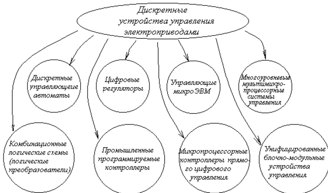
Рис. 6.26. Классификация дискретных устройств управления по сложности решаемых задач
