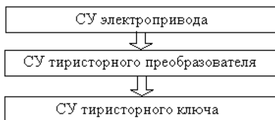
Рис. 6.3. Иерархия управления в электроприводе по системе «преобразователь — двигатель»
