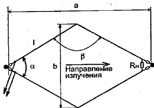
Рис. 101. Ромбическая антенна
