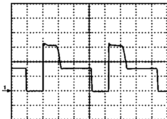
Рис. 3.6. Форма напряжения на коллекторе транзистора VT6
