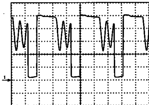
Рис. 5.15. Форма напряжения на ножке 3 DA2
