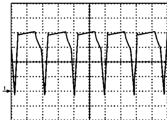
Рис. 6.17. Форма сигнала на резисторе R17 (рис. 6.9). Режим измерения: коэффициент канала 0,5 В/дел. и коэффициент развертки 5 мкс/дел.
