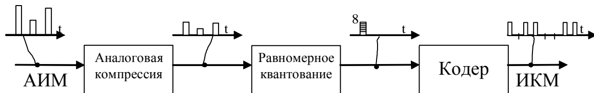
Рисунок 4.14 – Принцип аналогового компандирования
