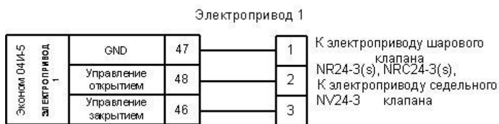
Рис. 9.6 – Схема подключения электропривода «Belimo» с трехточечным управлением к 1-му каналу
