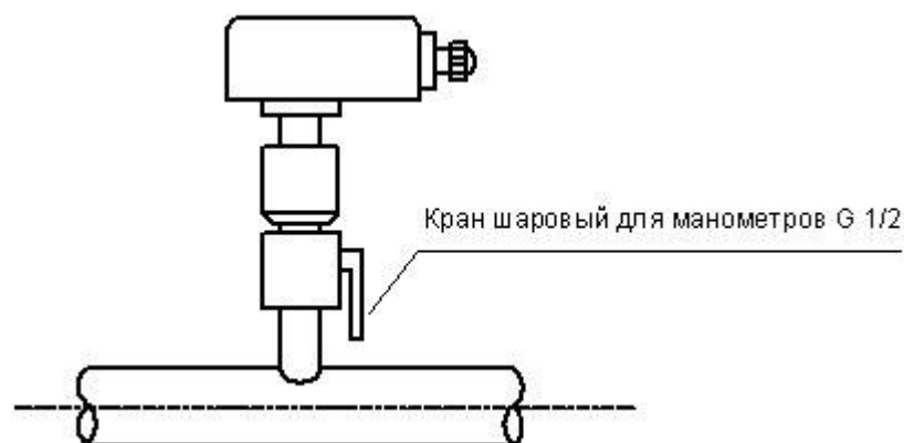
Рис.6.24 Установка датчика давления на трубопровод
