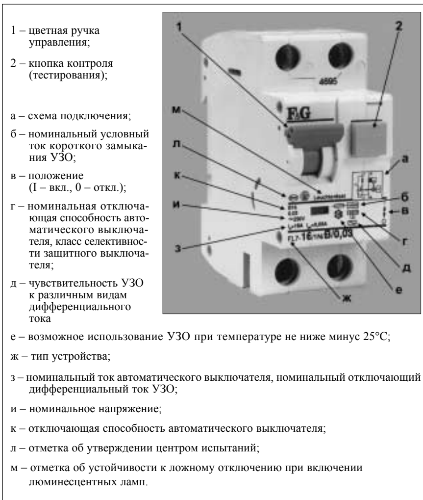
Рис. 23 Отметки на корпусе УЗО со встроенной максимальной токовой защитой
