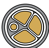
с круглой нулевой и сегментными фазными жилами
