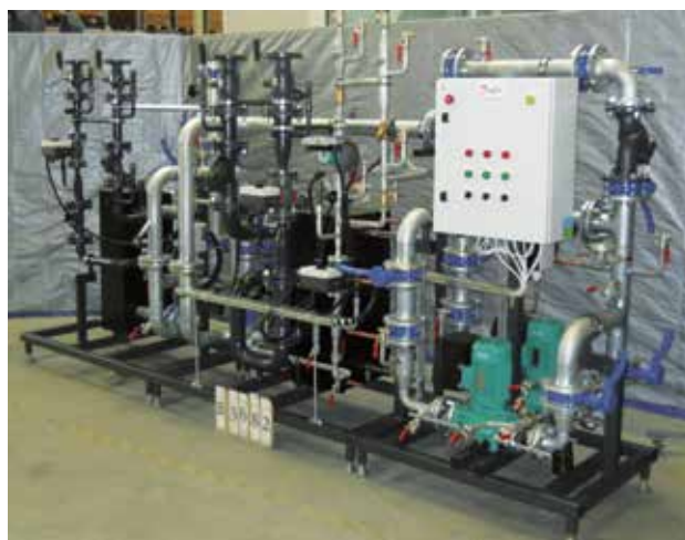
Рис. 34. БТП Danfoss с пластинчатыми теплообменниками.
