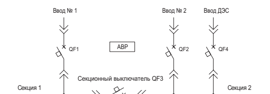
Рис 2.5 Схема «Два рабочих ввода с секционированием + ввод от ДЭС»
