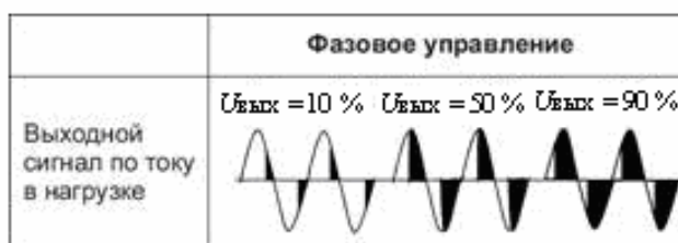
Рис. 96. Диаграмма срабатывания ТТР с фазовым управлением
