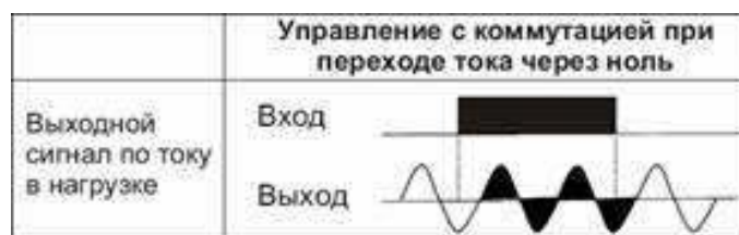
Рис. 94. Диаграмма срабатывания ТТР с контролем перехода через ноль
