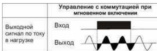
Рис. 95. Диаграмма срабатывания ТТР мгновенного включения
